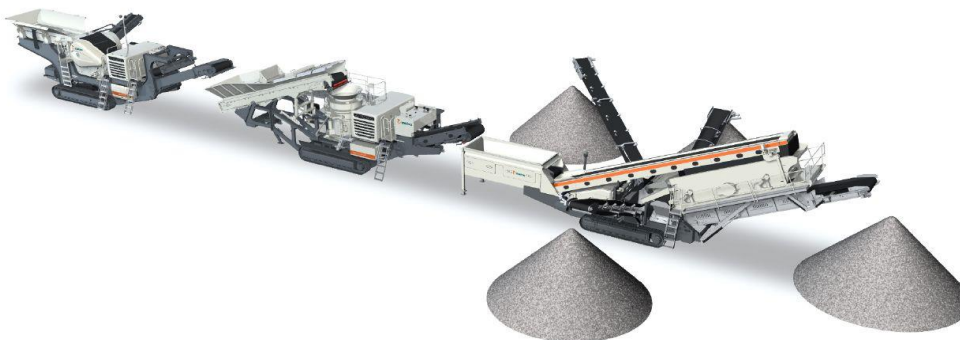
Gráfico N°10.3 Propuesta de layout en la zona de zaranda y chancado
