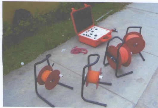
FOTOGRAFIA N° 01: Georesistivímetro Transmisor –Receptor marca Warg Power Modelo G 1120, utilizado en la ejecución de Sondeos Eléctricos Verticales–SEVs
