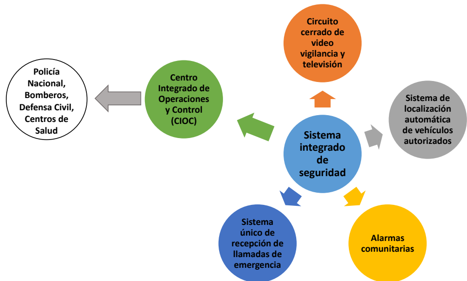
Figura 27 Sistema integrado de seguridad
