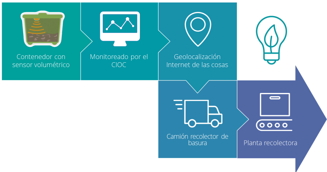
Figura 29 Modelo de sistema de recojo de residuos sólidos
