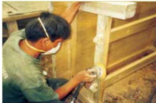
Tipos de máquinas lijadora a considerar: Lijadoras de banda y lijadoras orbitales con las siguientes características:
