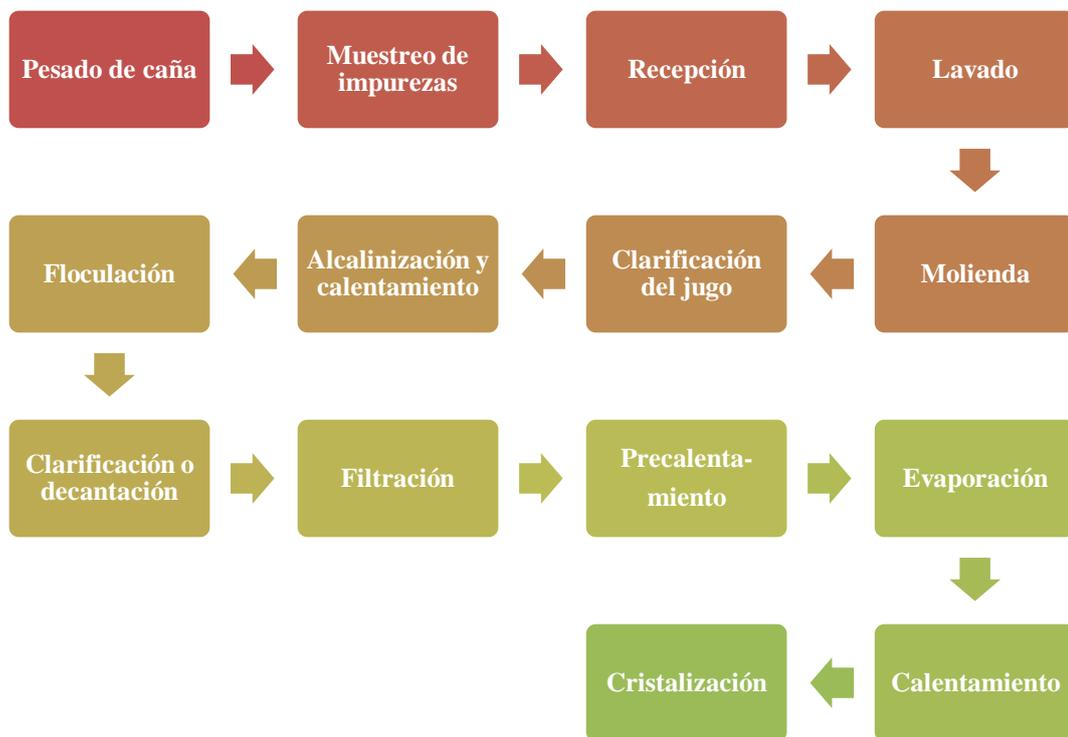
Descripción del proceso de producción para la obtención de azúcar:
