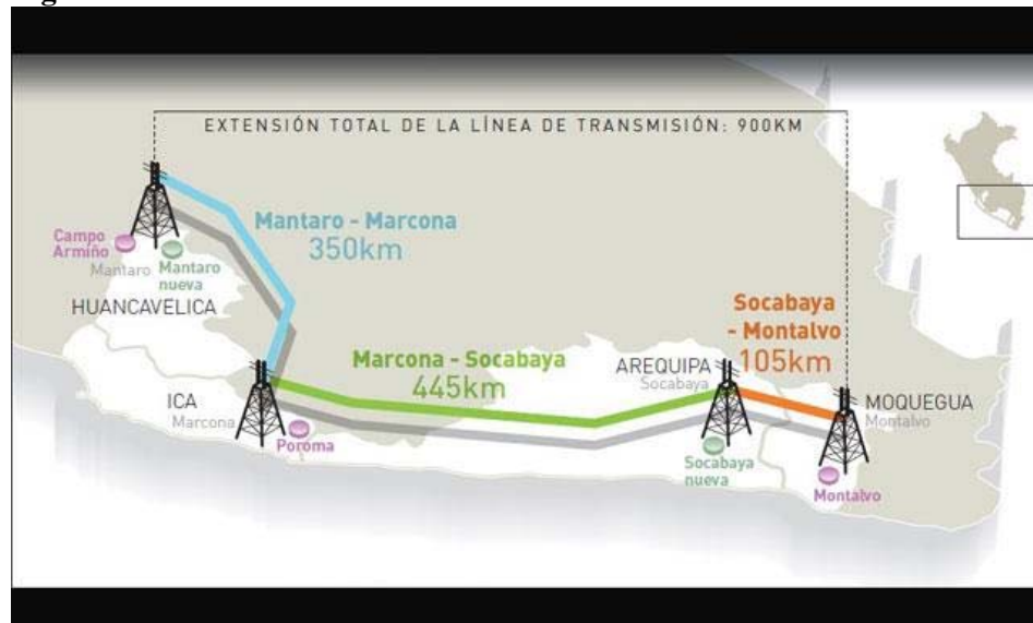
Figura 2.2. Línea transmisión 500kV Mantaro-Montalvo
